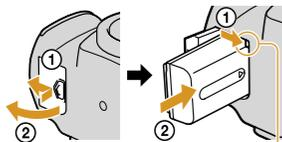
Плотно вставьте батарейный блок до упора, нажимая рычаг фиксатора краем батареи.
